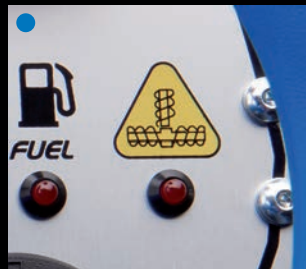
Warnsystem Überlastung Förderschnecken
