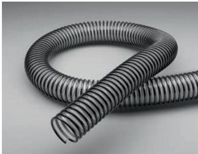
PU Folienschlauch, mikrobe- und hydrolysefest, extrem flexibel. Wandstärke zwischen den Spiralen ca. 0,6 mm, Biegeradius: z.B. DN200 = 200 mm, Gewicht 1,8 kg/m
