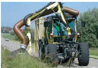
**PU Grossgeräte Laub- und Grassaugschlauch mikrobenresistent.** Wandstärke zwischen den Spiralen ca. 1,7 mm
