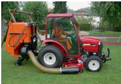
PU Absaug-/Förderschlauch für Gras-Rasenmäher und Laubsauggeräte. **Sehr flexibel, öl- und benzinfest hoch abrieb-, vakuum- und mikrobe-resistent.** Wandstärke zwischen den Spiralen ca. 1,4 mm, Biegeradius: z.B. DN200 = 321 mm, Gewicht 3,5 kg/m
