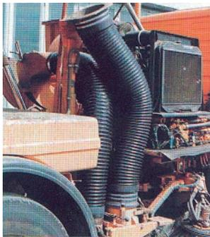
**PU Grosskehrmaschinen Saugschlauch hoch abrieb-, vakuum- und mikrobenresistent.** Wandstärke zwischen den Spiralen ca. 1,8–3,4 mm
