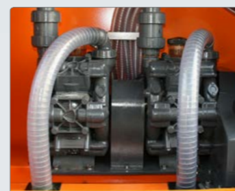
Logisch aufgebautes Flüssigkeitssystem mit Membranpumpe.
