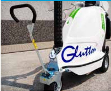
Deichsel beidhändig nutzbar für Links- und Rechtshänder
